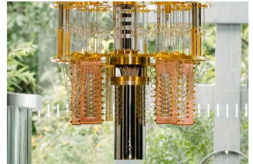
Photographie de la partie inférieure du cryostat d'IBM câblé pour porter le processeur de 50 qubits. ©IBM
