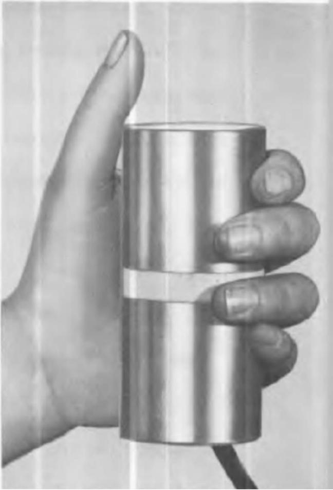
Figure 6 : Électrodes pour mains cylindrique en aluminium capables de détecter la réponse galvanique de la peau ainsi que les réflexes neuromusculaires.
